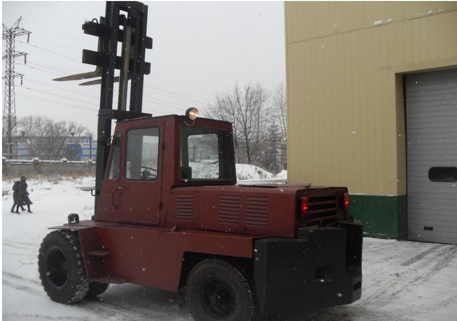
**Автопогрузчик АП40814 грузоподъемность 5 тн. высота подъема 3,3м. после проведения капитального ремонта.**
